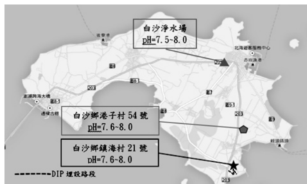
圖 3 白沙供水管網水質現況調查
