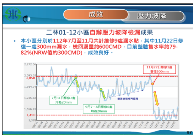
圖 12 0112 壓力坡降流量成效示意圖
