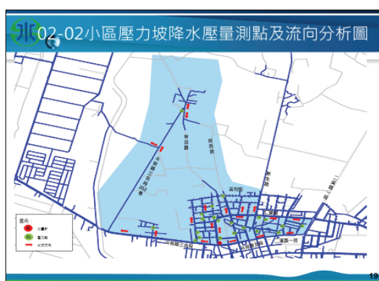
圖 6 0202 壓力坡降量測點示意圖
