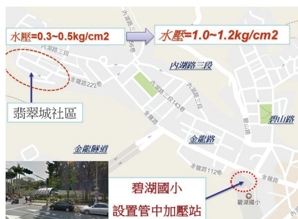
圖 2 管中加壓站水壓改善示意圖
