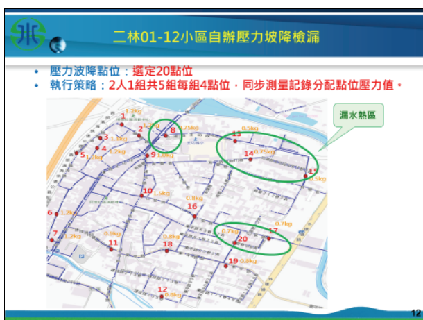
圖 4 0112 漏水熱區示意圖
