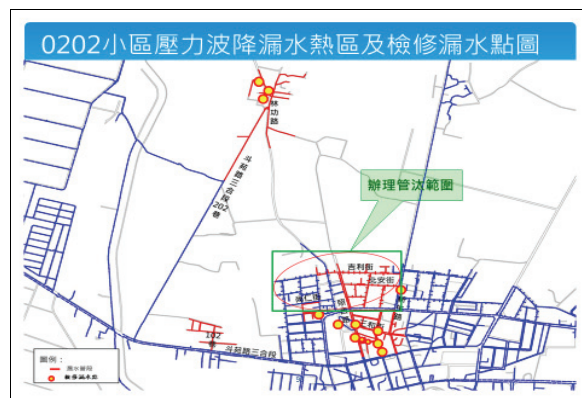
圖 13 0202 壓力坡降量檢漏汰換點位示意圖
