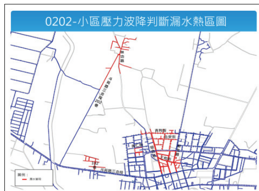
圖 10 0202 壓力坡降量漏水熱區示意圖
