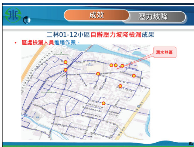
圖 11 0112 壓力坡降量檢漏點位示意圖
