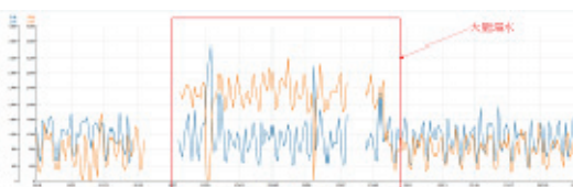
圖 13 漏水前中後小區流量計表現情形
