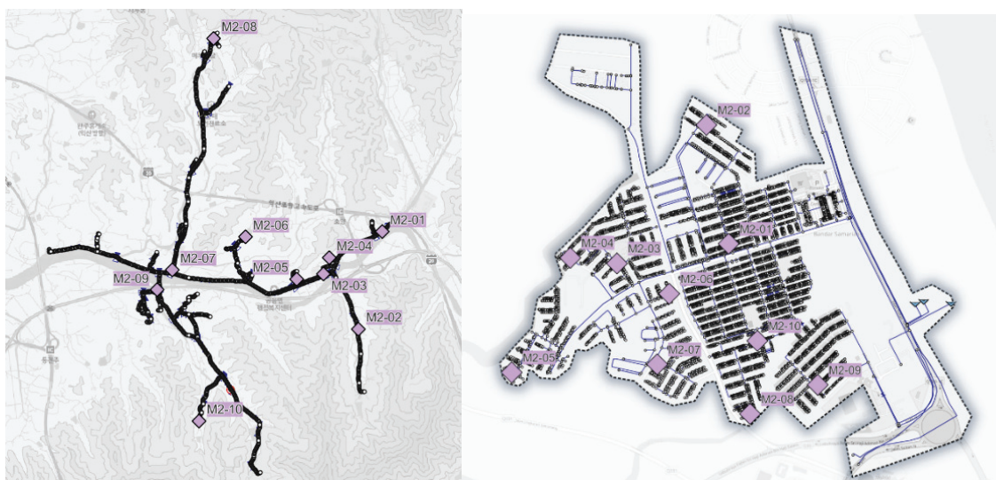
圖 2 供水管網關鍵點佈設壓力感測器
