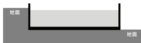
圖 4 配置於不平整地面之水池側面示意圖
