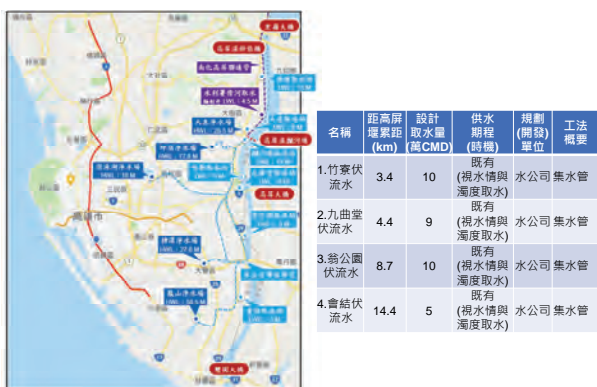
圖 5 高屏堰以下伏流水工程概況
