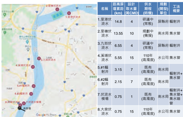
圖 6 高屏堰以上伏流水工程概況
