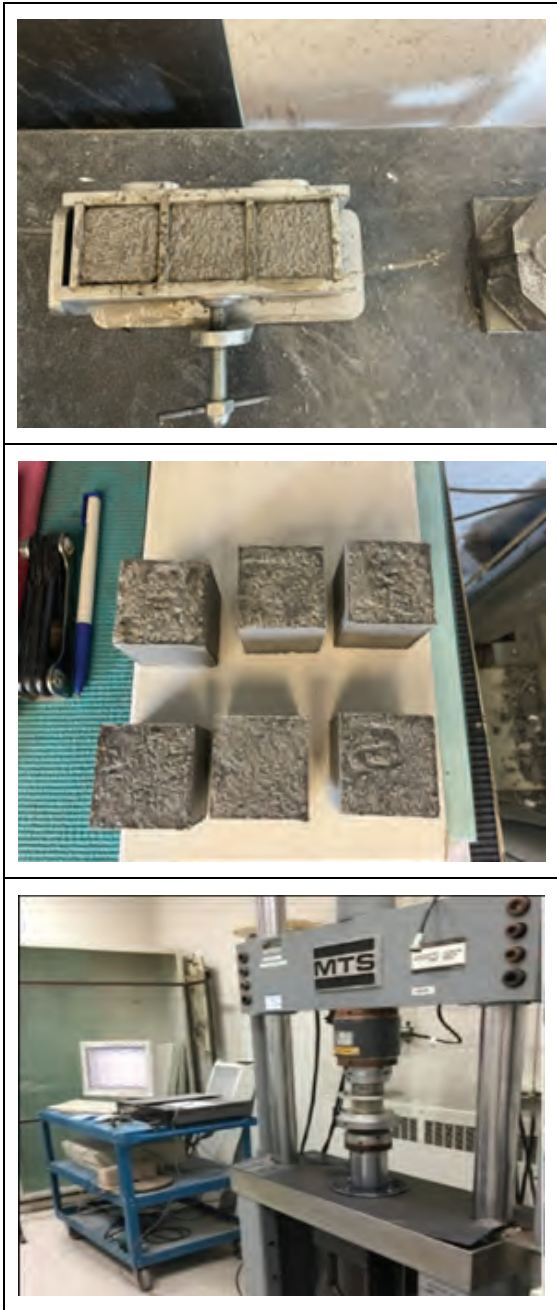
圖 7 水泥砂漿試體抗壓強度試驗
