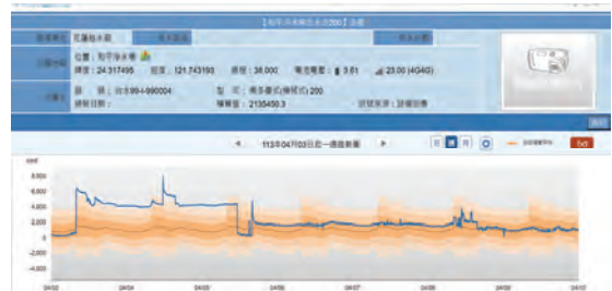
圖 19 和平系統週瞬間流量分線圖，查係公路局中仁隧道北口機房 \phi 75 用戶表的內線大漏水(含消防用)，由 3 月份平均 77CMD 驟增至約 840CMD，顯見大震後的內線漏水量，足以影響對漏水趨勢的判斷。
