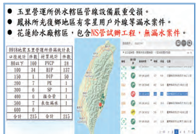
圖 10 0918 玉里地震 NS 耐震管試辦工程，查無漏水案件
