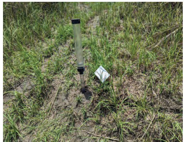
圖 9 ETC Pask 入滲儀現地入滲試驗示意圖
