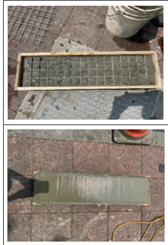
圖 8 拱型護板整體試體製作
