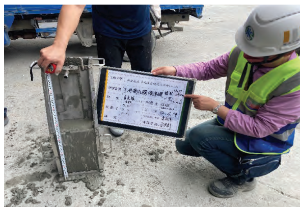
圖 13 自充填混凝土材料性質抽驗
