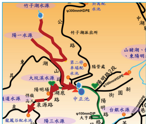
圖 12 第一水源切換為反沖洗水源
