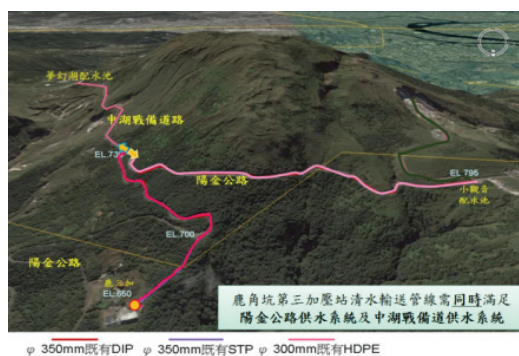
圖 8 鹿角坑第三加壓站供水示意圖
