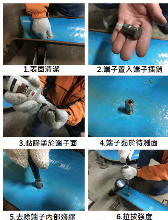
圖 10 拉拔試驗步驟
