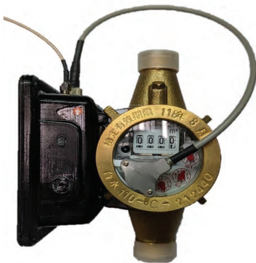
圖 5 機械水表外掛照相裝置
