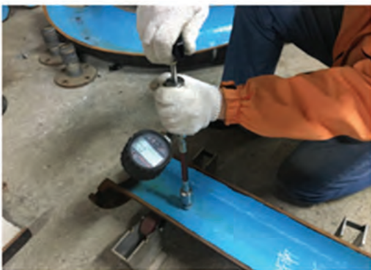
圖 2 管材剖半切割有利試驗進行
