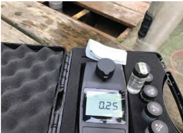
圖 5 擴水洗井以現場濁度量測管理施工品質
