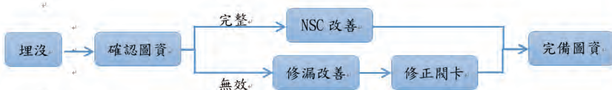
圖 2 修正閥栓圖資流程
