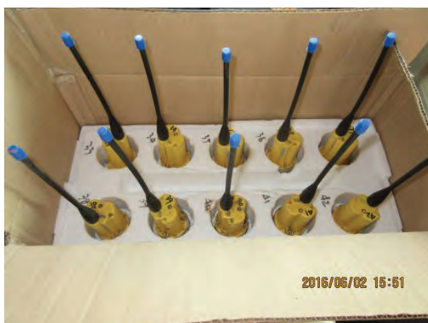
圖 5 2000(89)年台水購入的噪音紀錄器(漏水分析儀)
