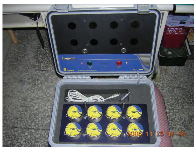
圖 6 2006(95)年英國 PRIMAYER 公司的多點漏水相關儀
