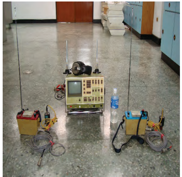
圖 2 1985(74)年台水引進日本富士公司和英國 W.R.C.開發的箱型「兩點漏水相關儀」
