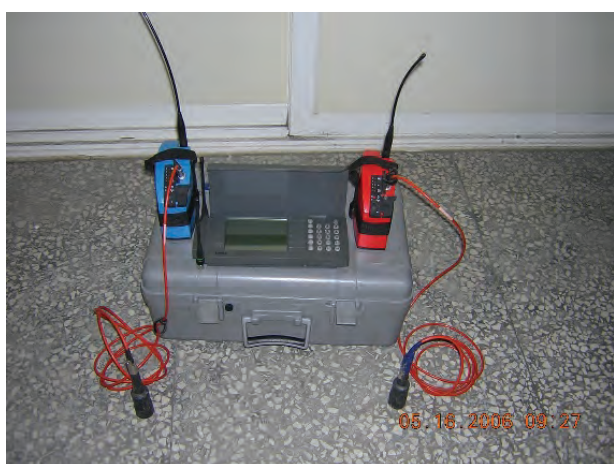
圖 3 2001(90)年台水購入升級版的掌上型「兩點漏水相關儀」
