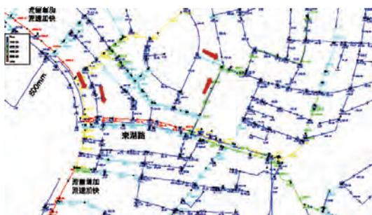
圖 13 東湖地區關閉  $800\text{mm}$  後管網水流方向改變
