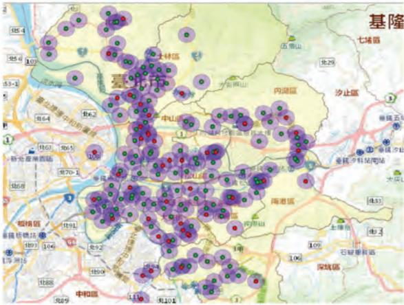
圖 16 模擬各項緊急供水設施服務範圍圖
