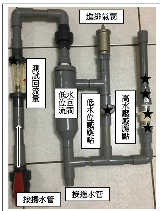
圖 3 改良式揚水測試設備零組件組裝
