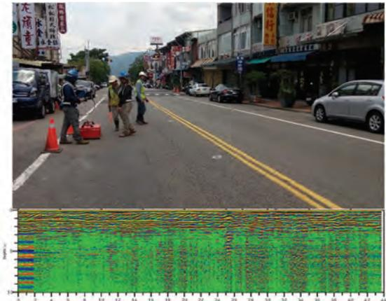
圖 16 透地雷達檢測過程及成果示意圖
