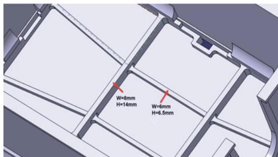
圖 10 40 型水量計箱結構優化#1 肋條加高至 14mm
