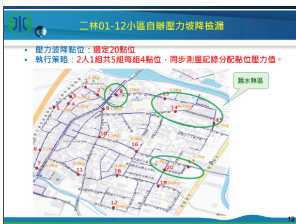
圖 4 0112 漏水熱區示意圖
