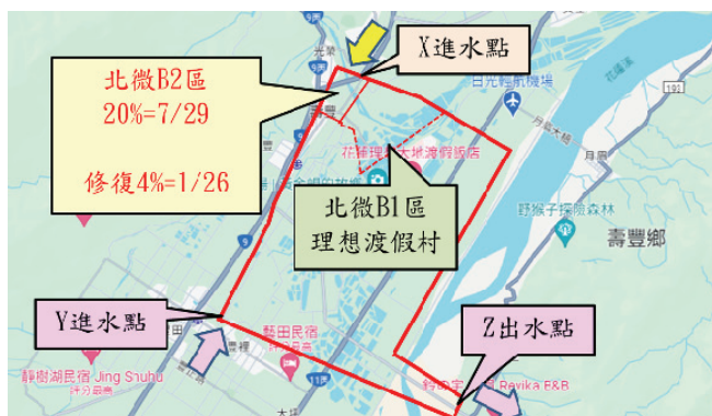
圖 4 將理想渡假村 B1 區移除 X 進水點計量範圍，北微 B2 區最小率 20%，雖 <30\% ，惟經技優檢漏員仍在該管段檢出漏水點
