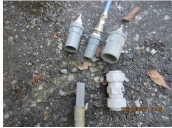
圖 12 備三組小管徑之異徑快速接頭及可繞式接頭，可視舊管外線管徑，即時更換連接
