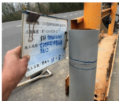
圖 1 大池 150mm PVC 環向裂縫型態
