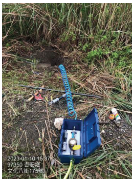
圖 6 以攜帶型小表計量箱，引水測試
