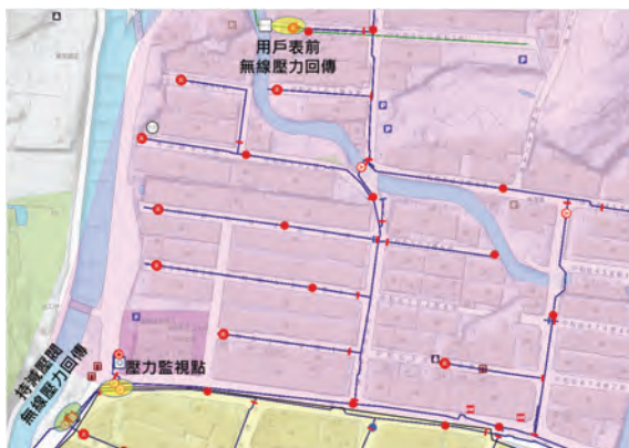
圖 2 無線壓力模組裝設地點
