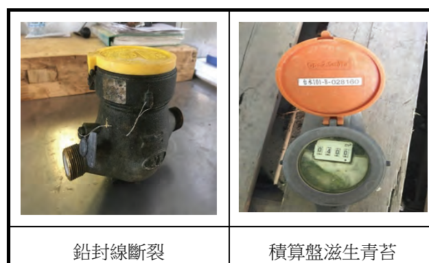
圖 2 台水自修之機械式水表故障態樣照片
