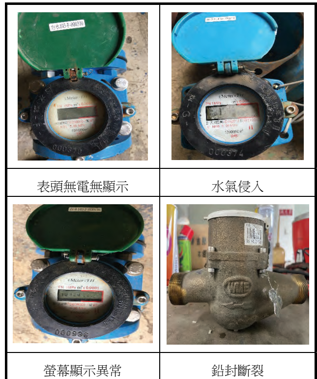
圖 4 常見之小型電子式水表故障態樣照片
