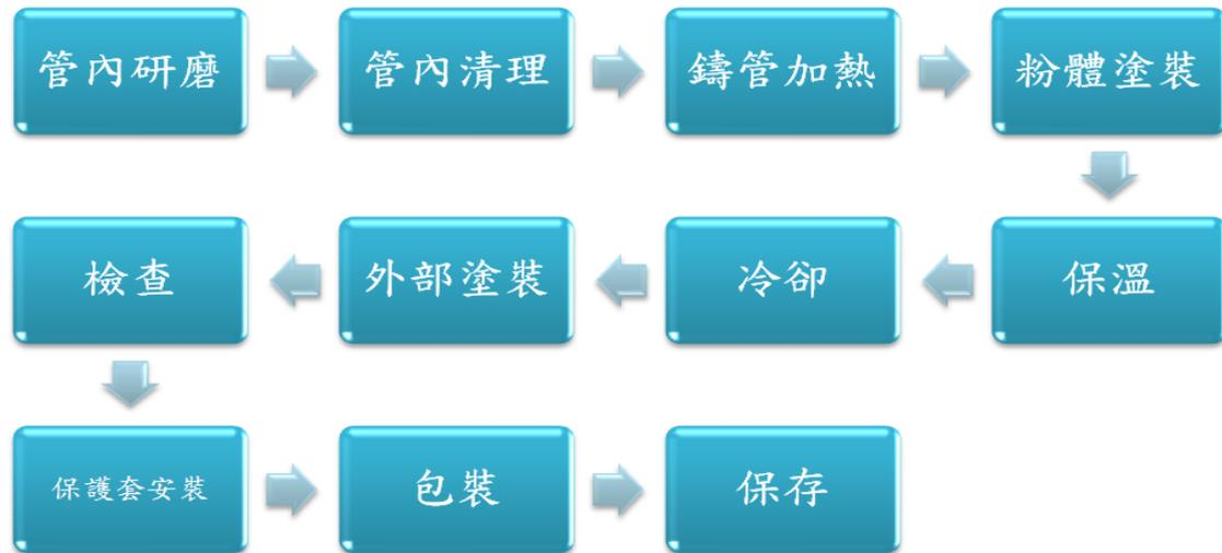
圖3-24 粉體內襯的製作流程
