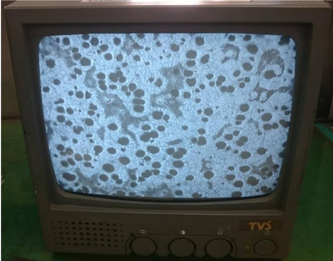
圖2-12 國內某鑄造廠的球墨鑄鐵金相照片
