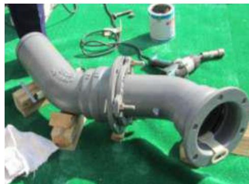
圖2-83 洛杉磯水電處LADWP引進久保田GX、NS型耐震管材<sup>71</sup>
