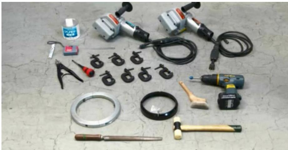
圖4-23 切管及插口製作配件
