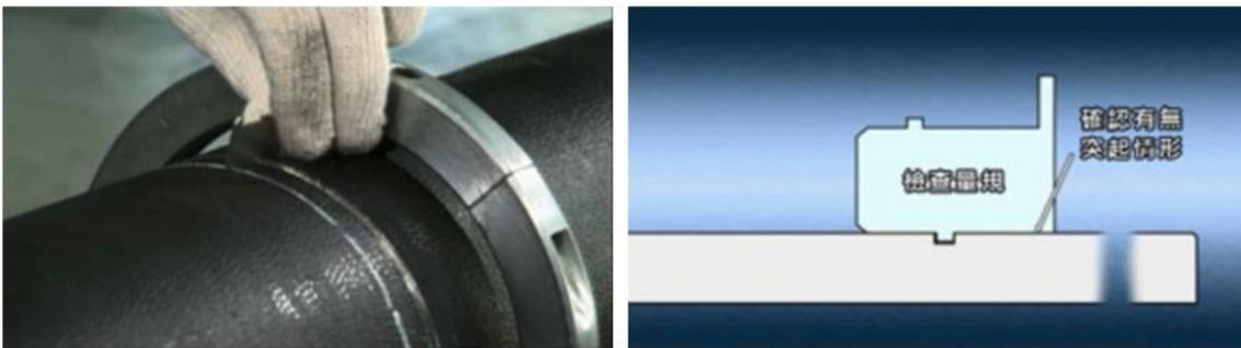
圖4-25 使用標準量規確認溝槽深度
