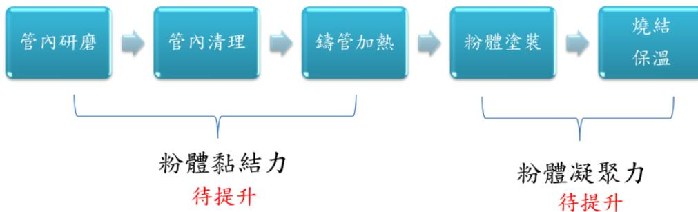
圖3-32 國內鑄鐵廠商管件粉體塗裝須提升的製程
