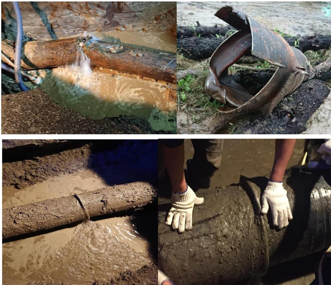
圖2-78 花蓮206地震發生的配水幹管挫曲破壞(台水九區處提供)
