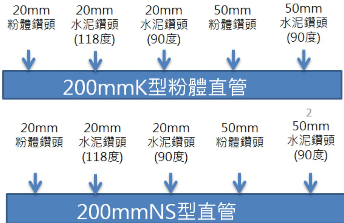
圖5-20 鑽孔規劃示意圖
