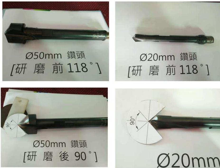
圖5-19 水泥鑽頭加工前後角度
