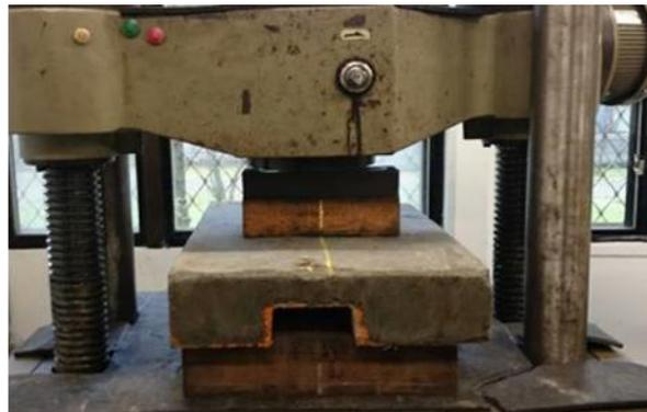
圖4-73 過溝蓋版進行載重試驗
