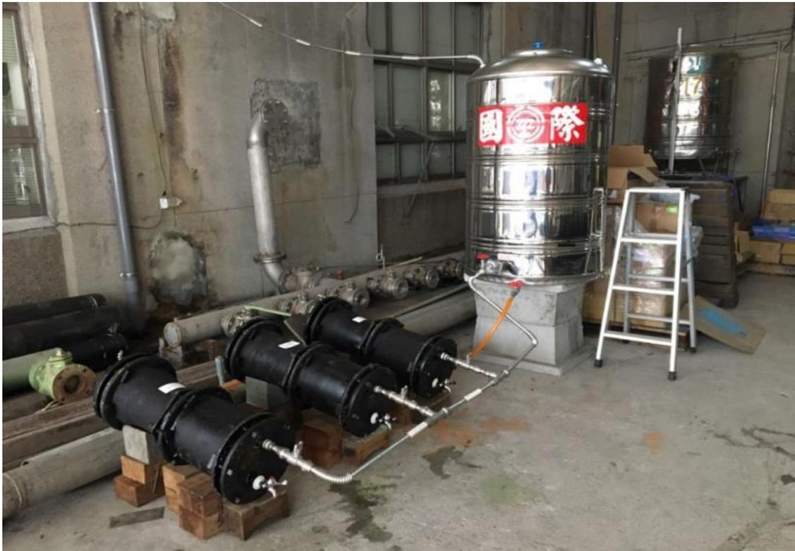
圖3-16 溶出試驗現場配置圖
