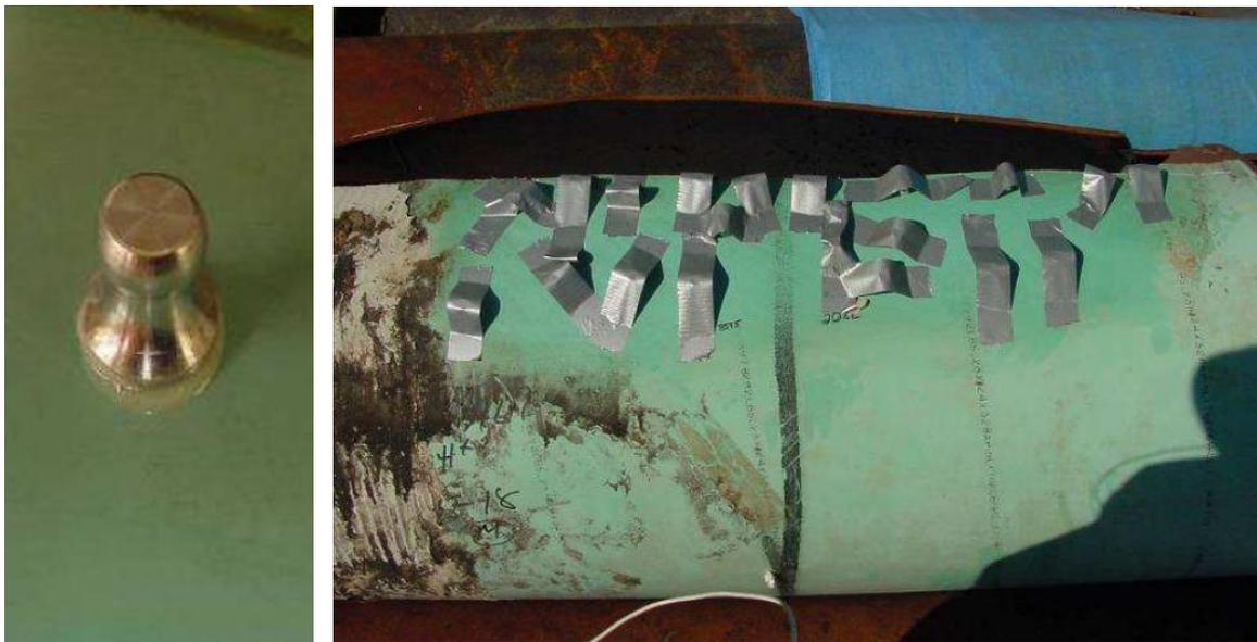
圖2-57 DNV公司以Type V型的拉拔器測試粉體強度<sup>56</sup>
