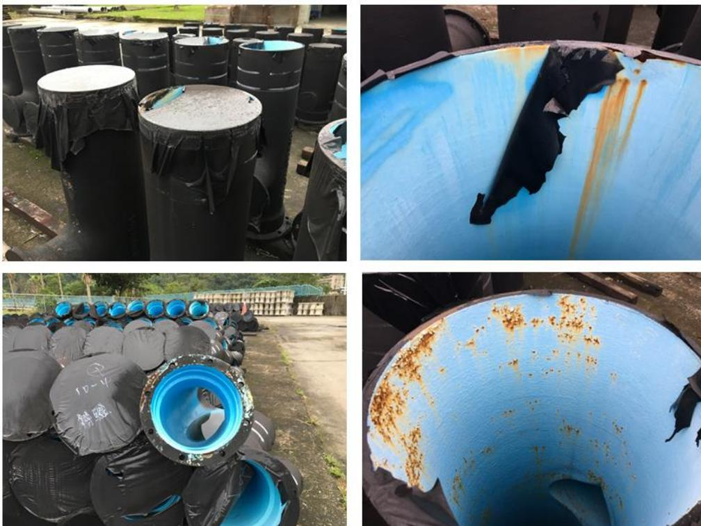
圖5-11 自粘性塑膠貼布破裂難以修補
