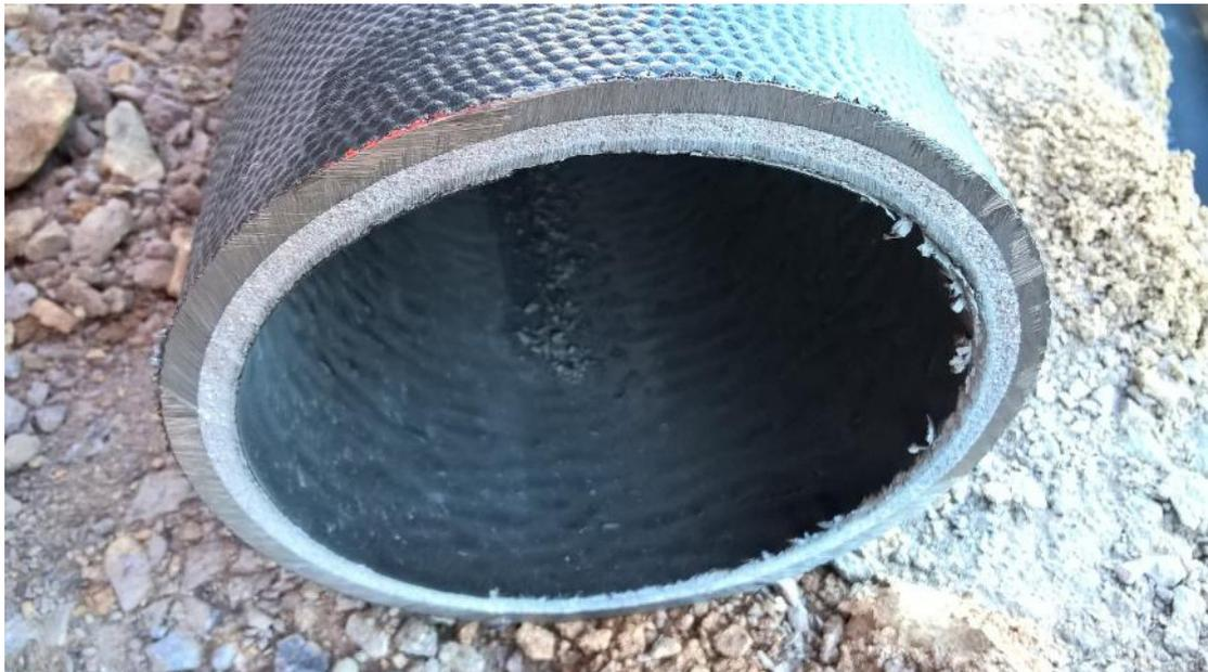
圖2-35 於水泥表層塗佈加密封塗層之水泥內襯鑄鐵管<sup>23</sup>
