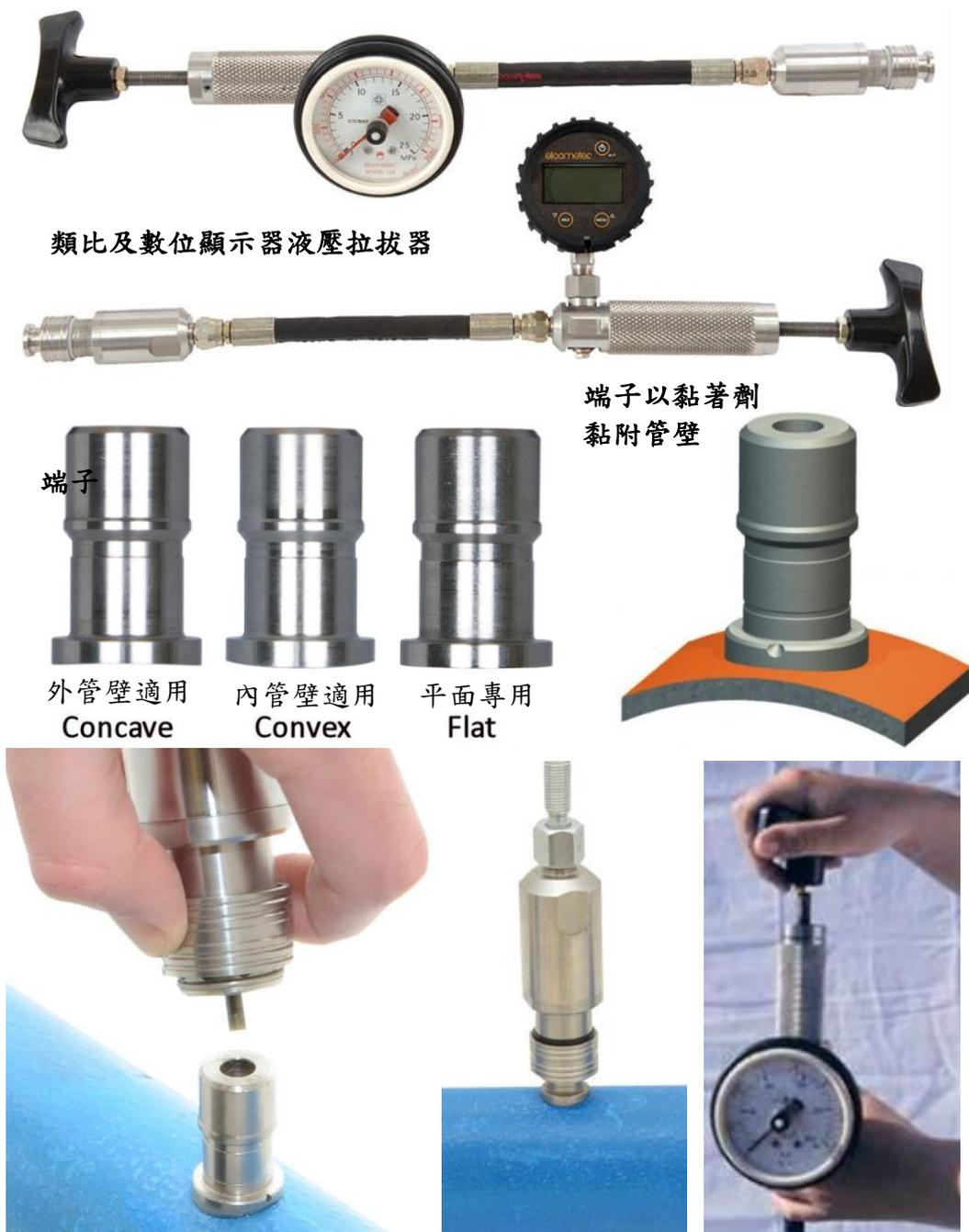
將拉拔器中心軸插入端子，並頂住管壁，以提供拉拔反力。拉拔器的抓環(Grip)咬住端子外側凹溝，隨著轉動液壓器，端子承受上拔力將漸漸增加，直到拔斷脫離
