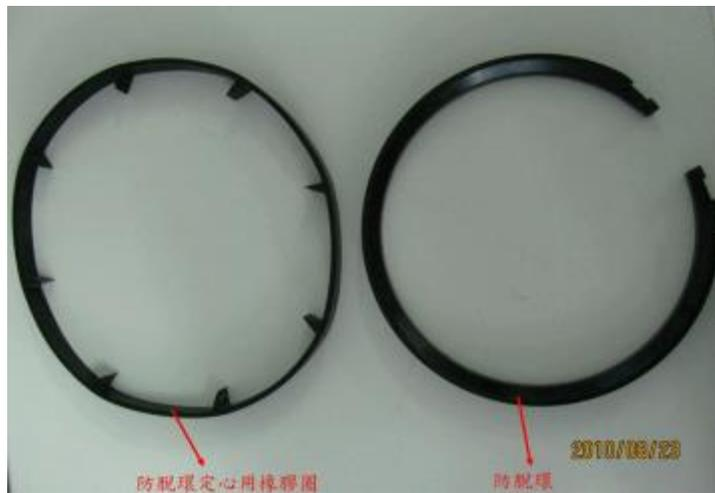
圖4-6 NS型耐震接頭防脫環定心橡膠圈和防脫環
