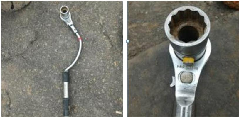
圖4-52 耐震接頭(NS型)所使用之扭力扳手
