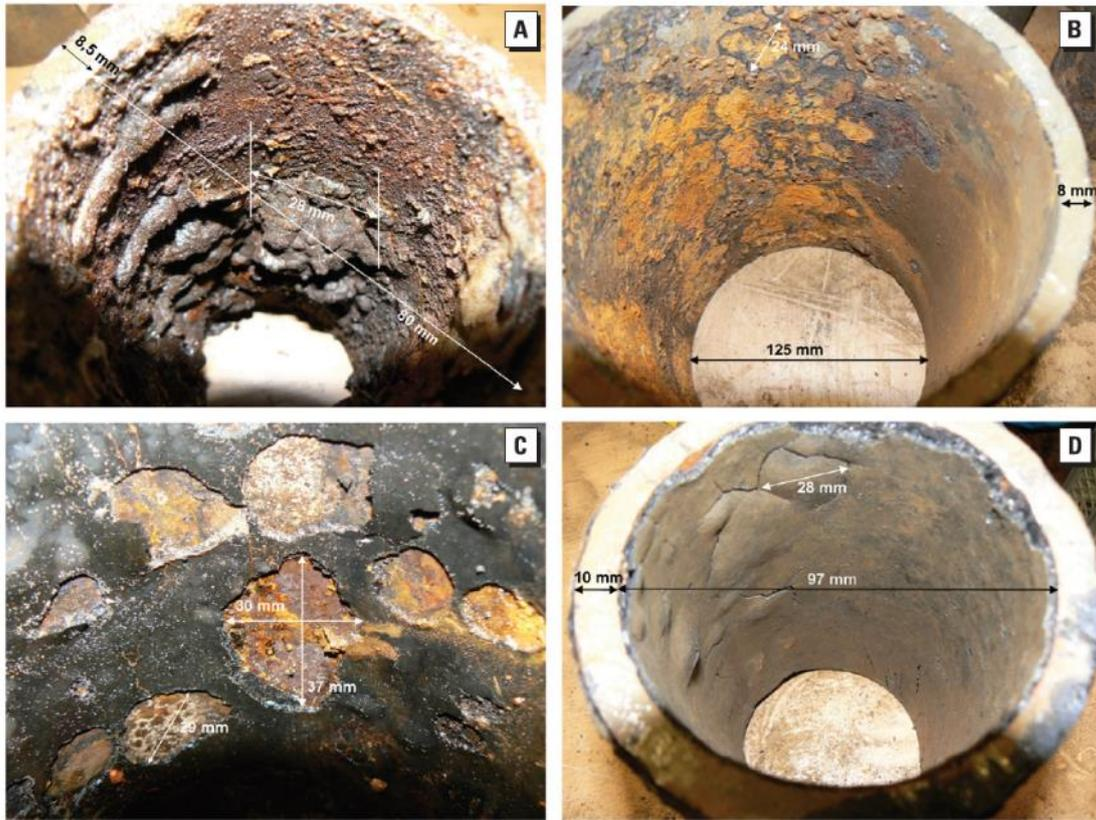
圖2-33 不同厚度煤焦油塗佈鑄鐵管的損壞比較(D最厚)<sup>25</sup>
