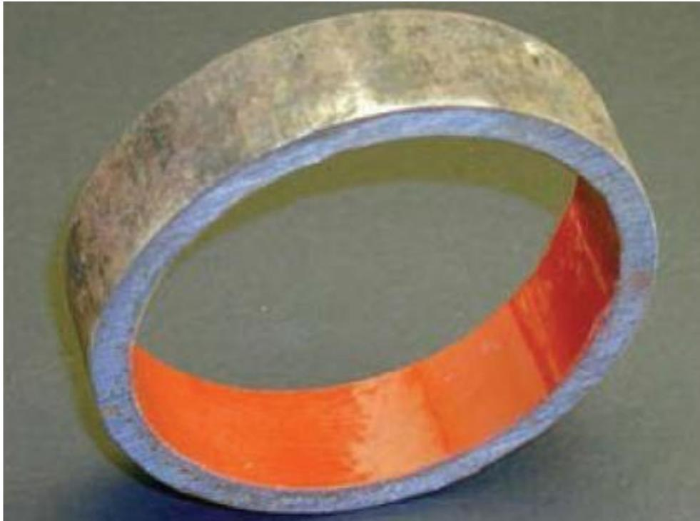
圖2-36 僅塗布環氧樹脂的鑄鐵管<sup>18</sup>
