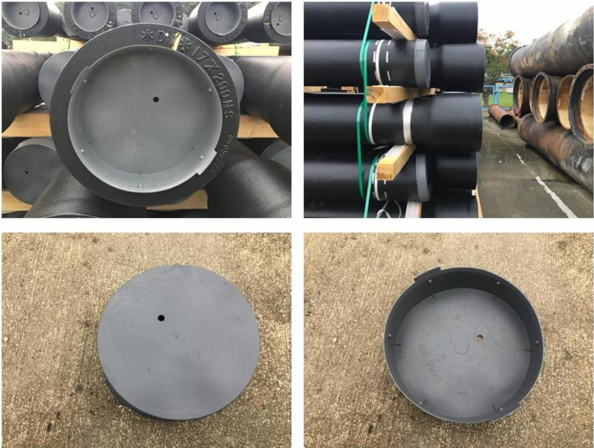
圖5-12 蓋子進行封口避免粉體塗裝劣化
