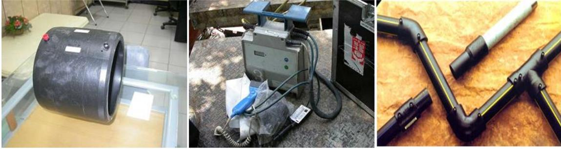
圖4-93 電套銲熔接法施工示意圖
