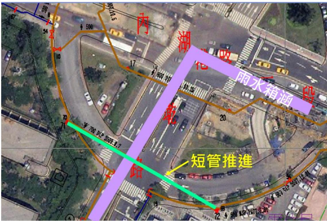
圖4-79 配合雨水箱涵進行短管推進範圍示意
