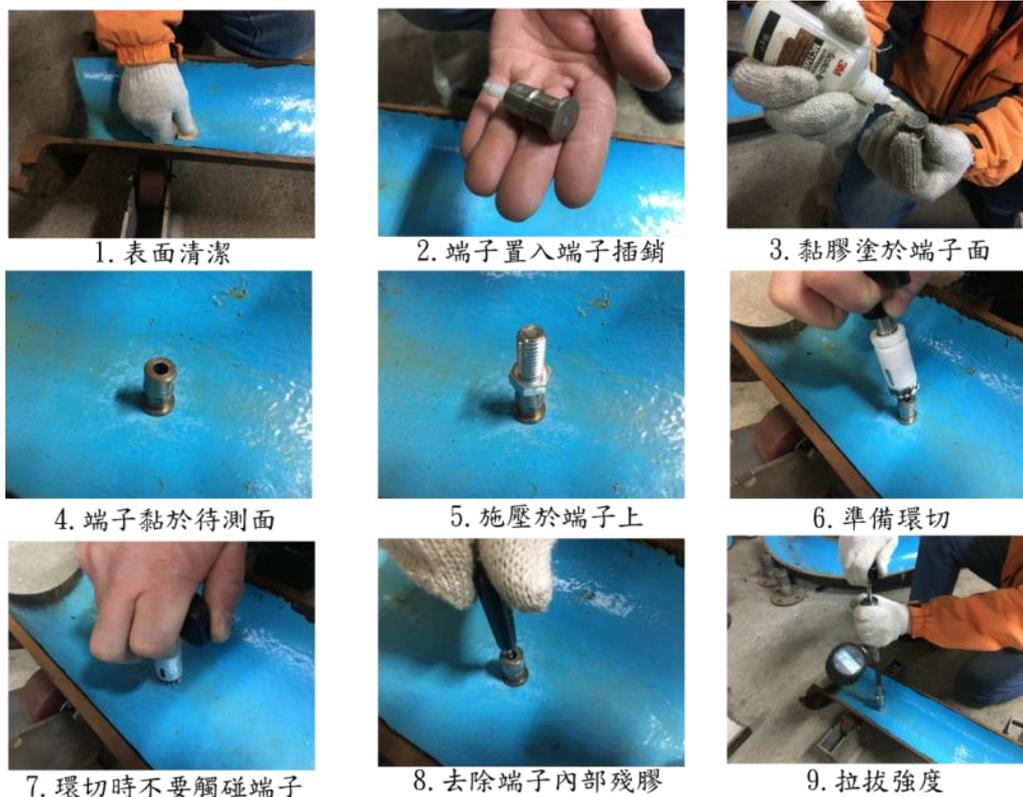
圖3-27 拉拔試驗步驟
