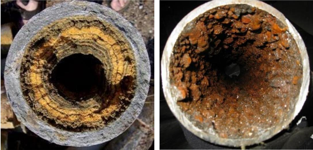
圖2-44 兩類不穩定的水質：沉積結垢(左)鑄鐵腐蝕(右)<sup>41、42</sup>
