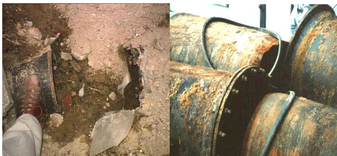
圖2-71 阪神大地震土壤液化管材浮起脫接、軸向壓縮損壞<sup>68</sup>
