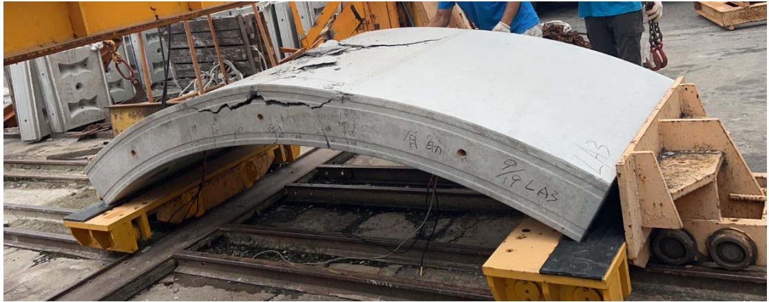
圖 117 一般鋼筋混凝土 A 型環片壓裂照片
