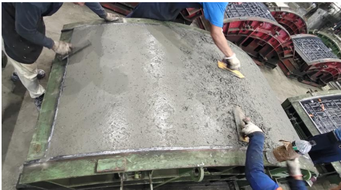
圖 99 A 型環片澆注完成表面修磨
