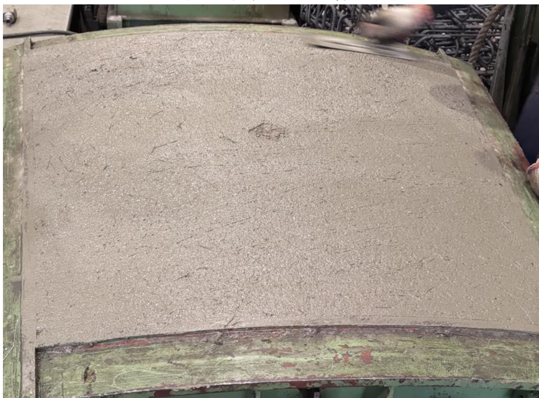
圖 100 K 型環片澆鑄完成表面修磨
