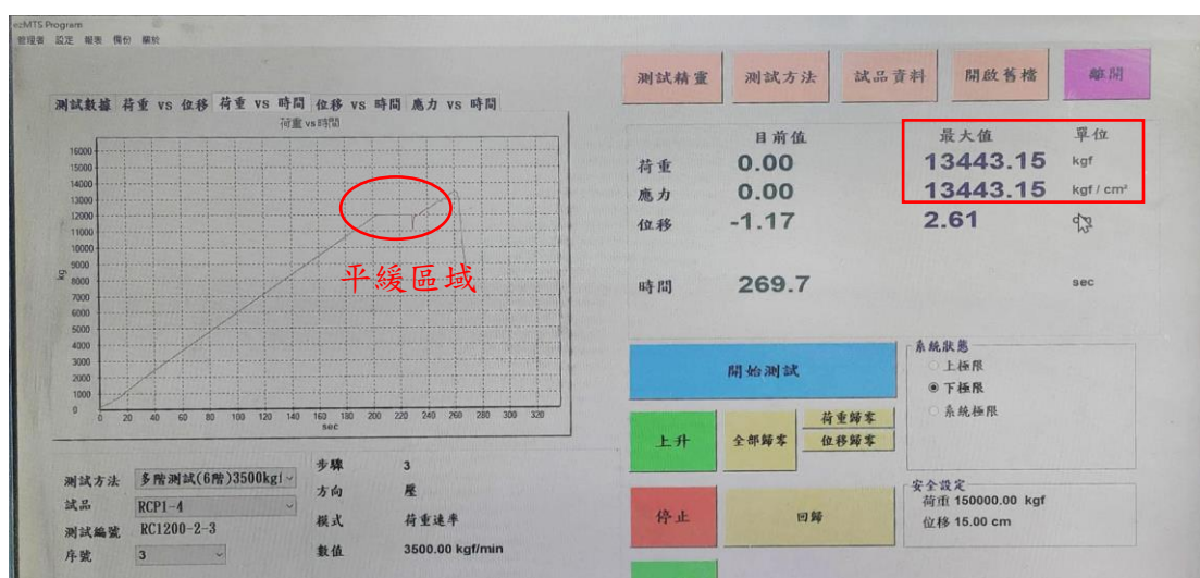
圖 121 實驗數據最大值 13.4 噸及出現應變延長之情形
