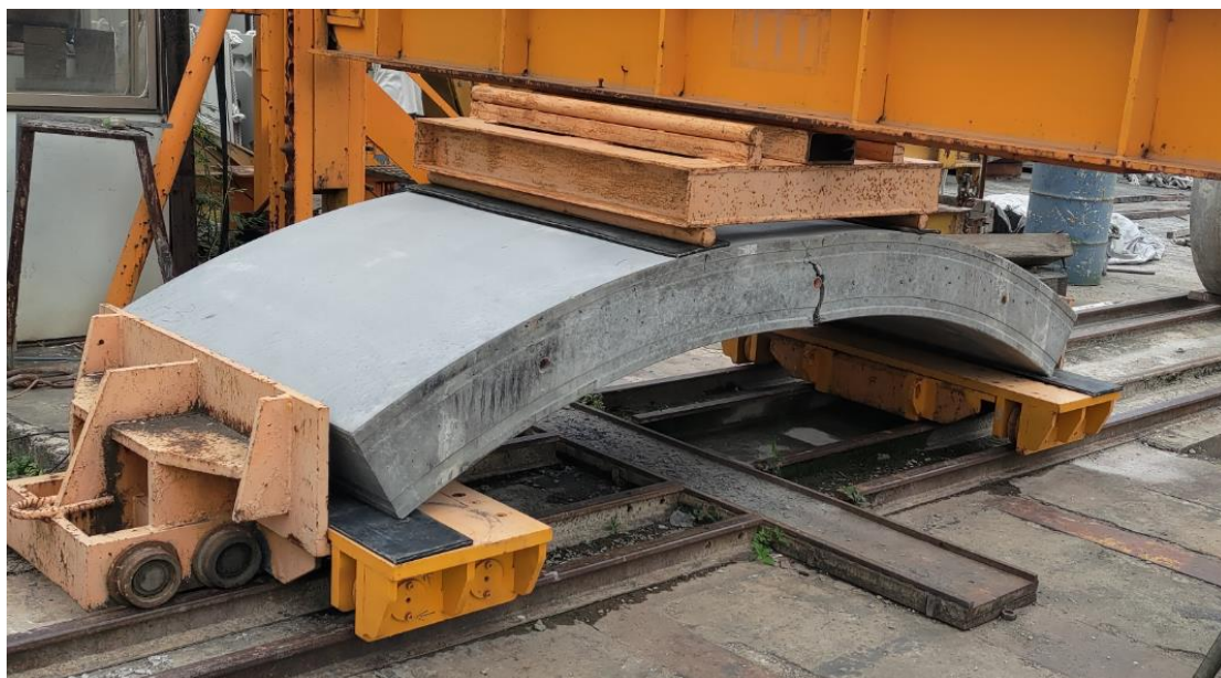
圖 120 鋼纖維混凝土 A 型環片壓裂狀態
