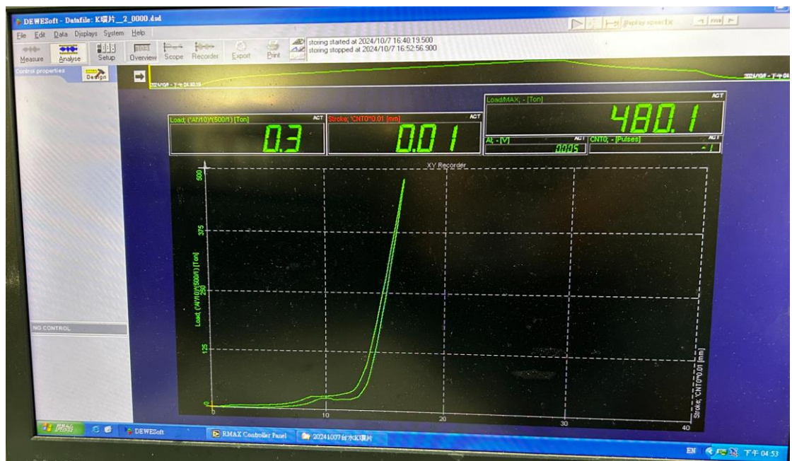
圖 130 鋼筋維混凝土 K 環片測試曲線圖
