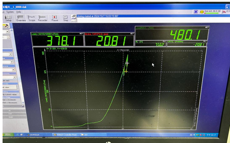
圖 132 鋼纖維混凝土 K 環片測試曲線圖
