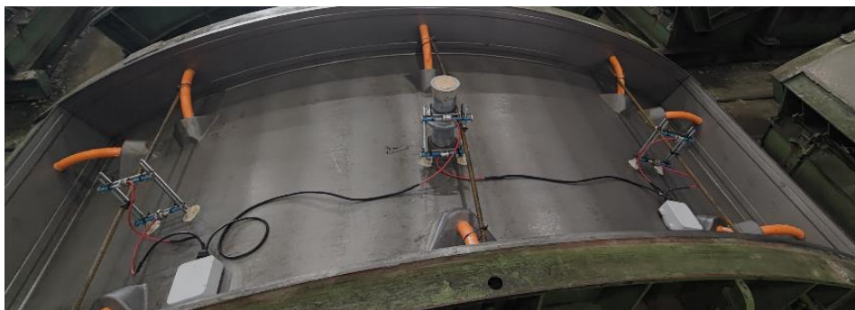
圖 93 無鋼筋 K 型環片安裝示意圖
