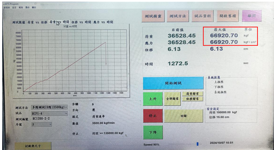
圖 118 實驗數據最大值 66.9 噸
