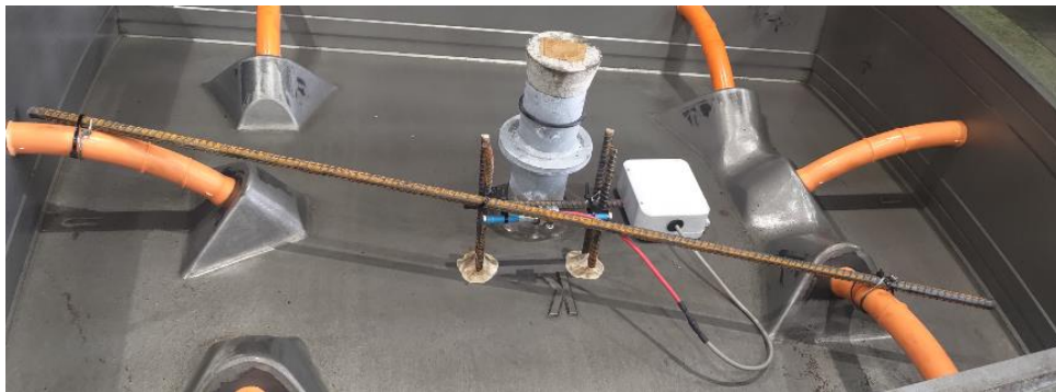
圖 93 無鋼筋 K 型環片安裝示意圖
