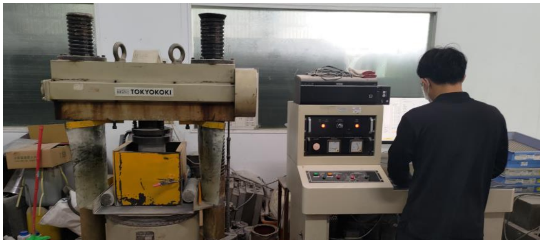
圖 111 圓柱試體試驗
