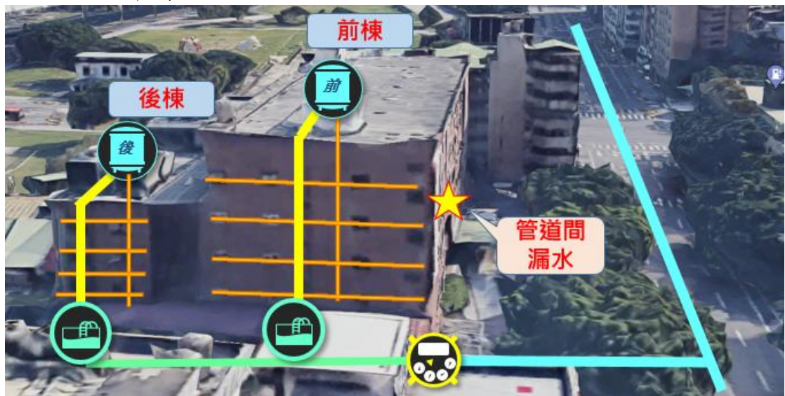
圖 73 案例 A1 建物與管線配置圖
