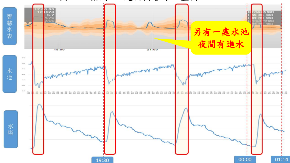
圖 90 案例 B2 智慧水表與水池水塔水位變化圖
