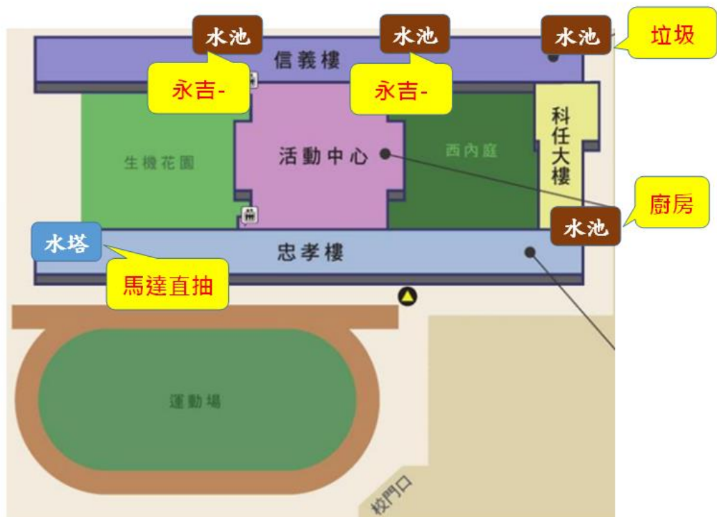
圖 131 案例 B13 建物與管線配置圖
