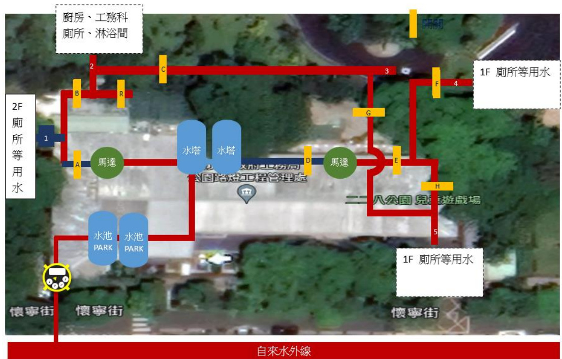
圖 80 案例 A3 建物及管線配置圖
