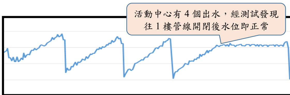
圖 117 案例 B8 智慧水表與水池水塔水位變化圖 (5)
