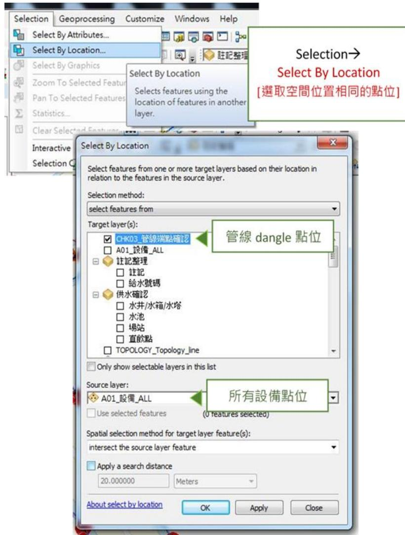
圖 71 比對管線端點與設備點位範例圖
