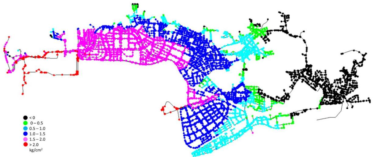
圖127 二十年後最大時需水量壓力分布圖
