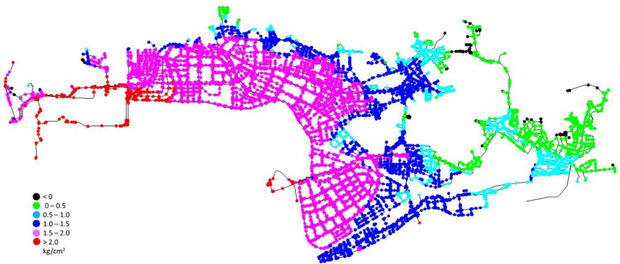
圖120 五年後平均日需水量壓力分布圖
