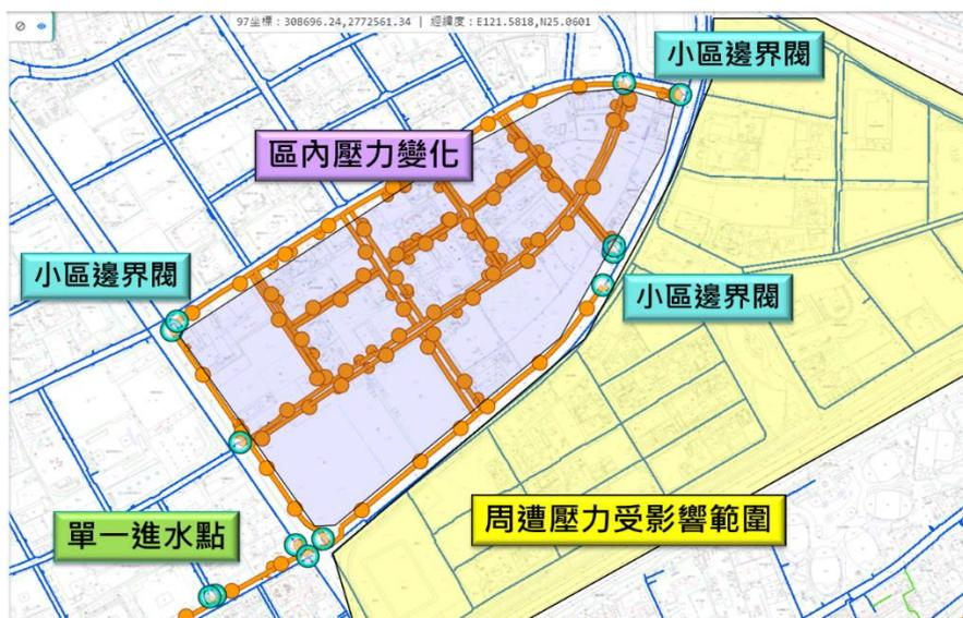
圖 168 Web GIS 系統評估小區封閉可行性示意圖
