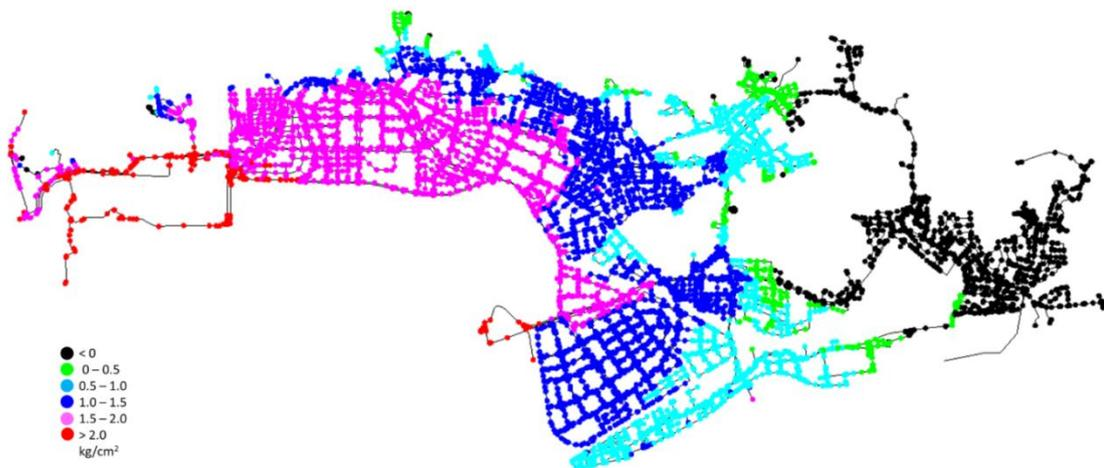
圖123 五年後最大時需水量壓力分布圖
