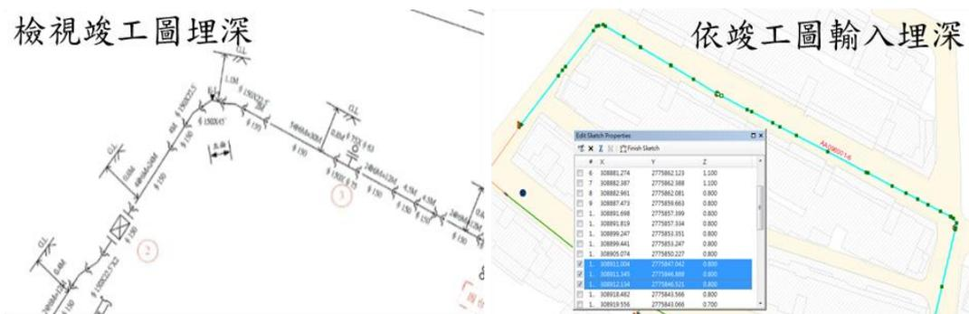
圖 63 依竣工圖輸入埋深示意圖
