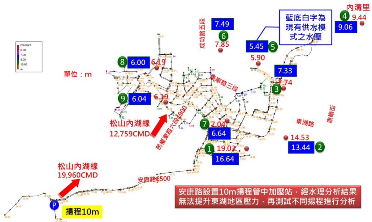
圖 178 新增加壓站方式水理分析結果
