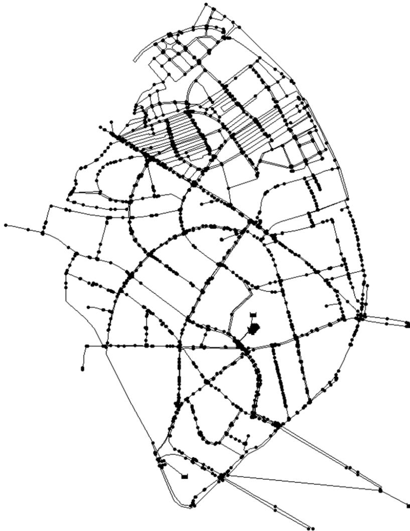
圖 157 三重供水分區管網水理模型
