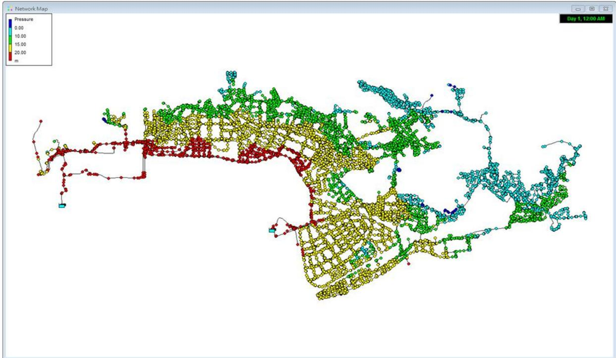
圖 93 內湖管網節點壓力分析結果示意圖
