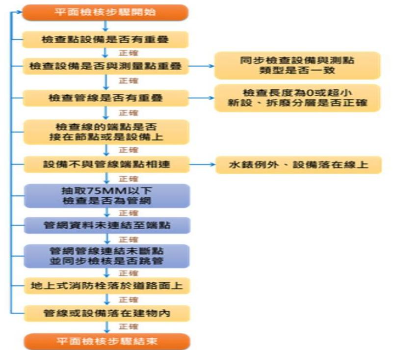
圖 65 平面檢核項目作業程序圖
