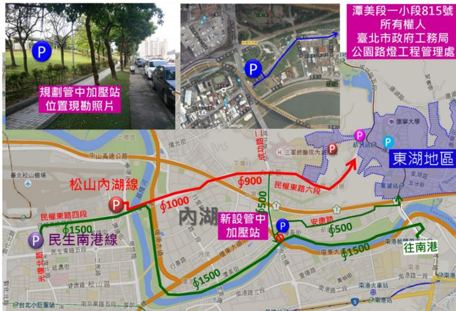
圖 177 新增加壓站方式以加速東湖地區復水時程
