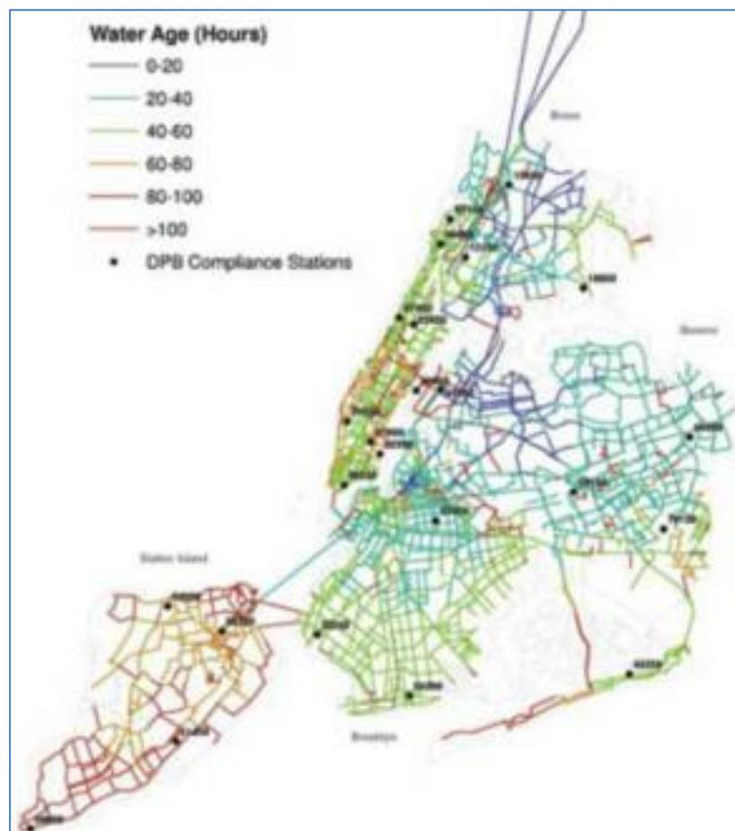
圖 16 紐約管網水齡分析，偏紅區域水齡高 DBP 濃度也較大<sup>11</sup>
