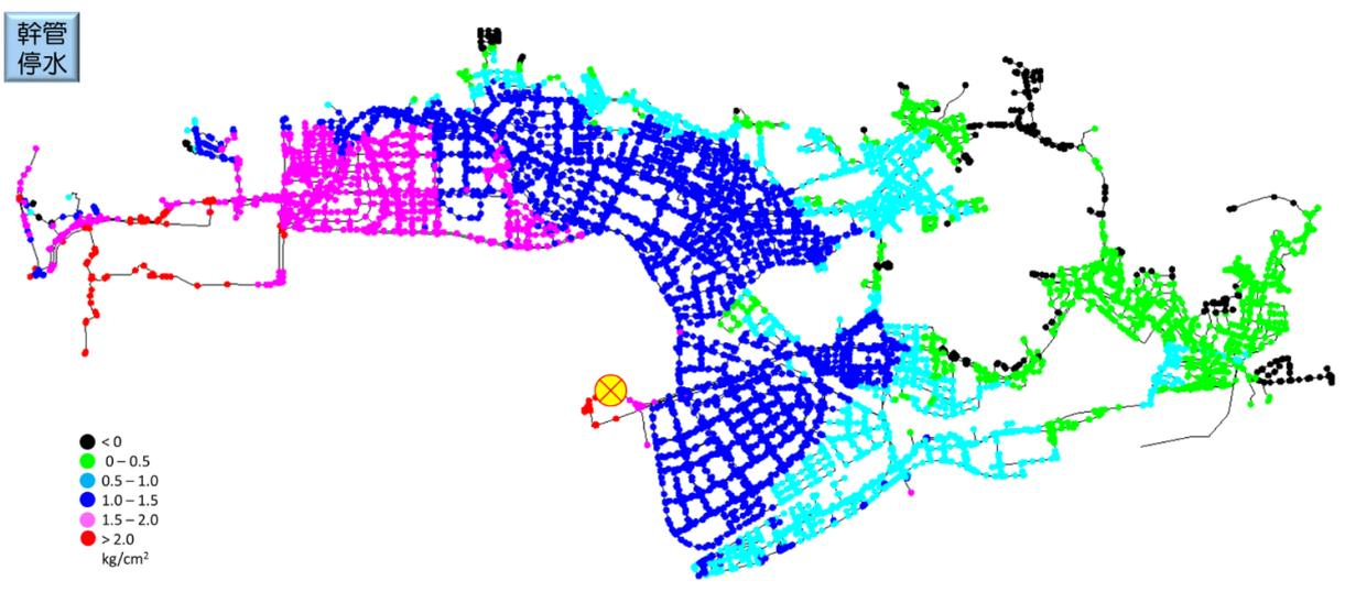
圖 136 松山內湖線出水分支管停水壓力分布圖
