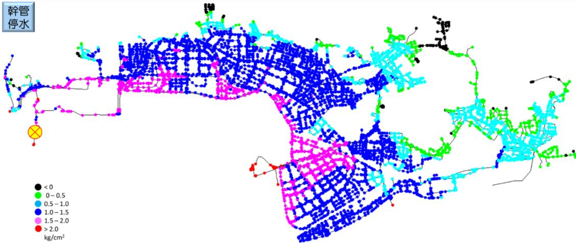
圖 134 大同大直線出水本管停水壓力分布圖
