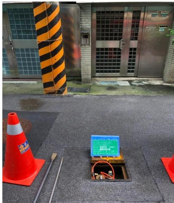
圖 97 現場實際水壓量測
