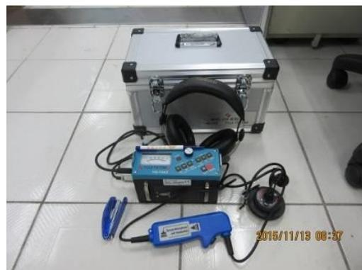
b.FUJI HG-A2 測漏器
