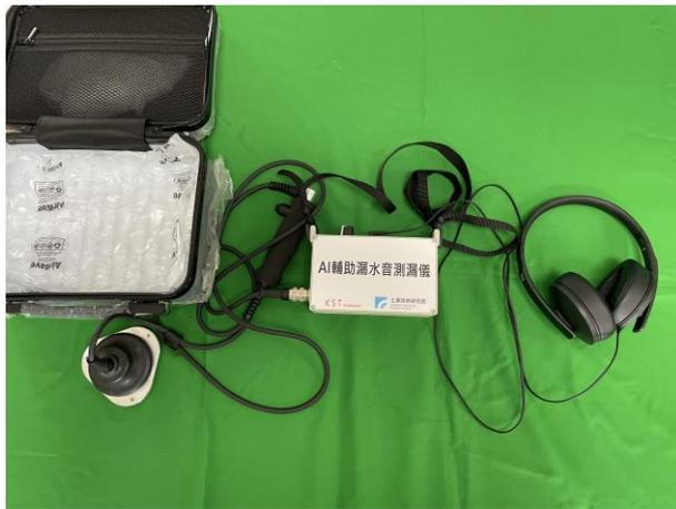
圖 24 AI 輔助漏水音測漏儀
