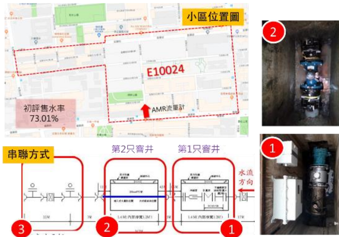
圖 4-12 北水處流量計串聯測試場
