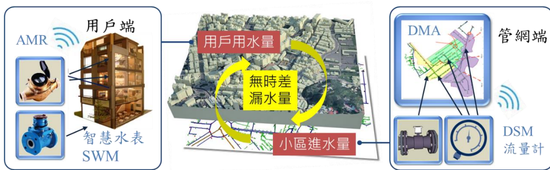
圖 5-1 用戶智慧水表結合小區計量作業
