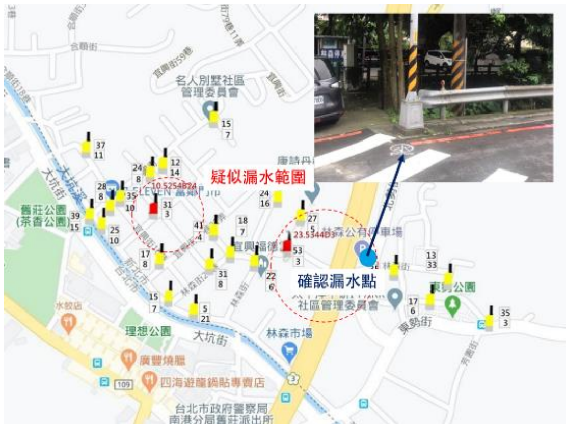
圖 3-27 E09019 進行小區健評發現漏水點
