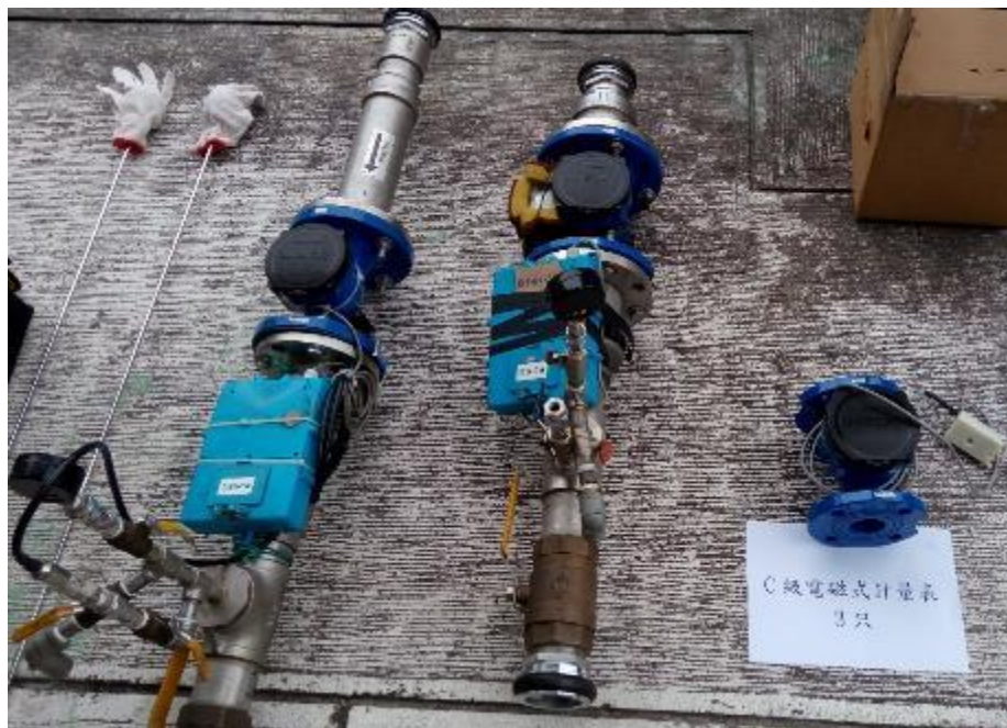
圖 4-8 搭配 50-100mmC 級電磁式流量計量測小區域流量
