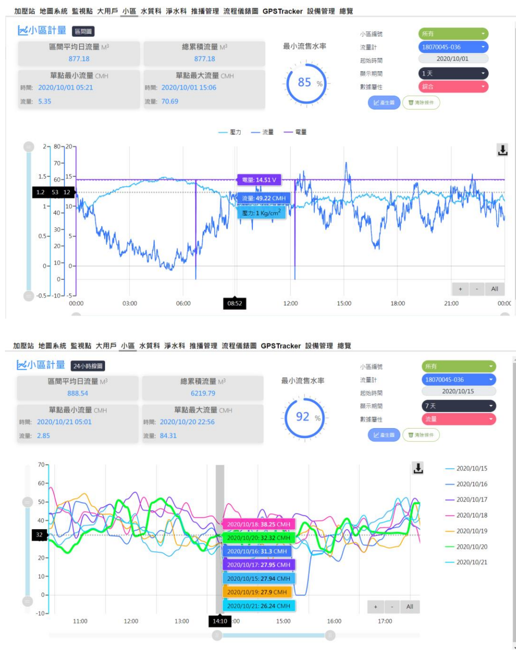
圖 6-20 DSM 收集之壓力、流量與時間趨勢圖(上)區間圖；(下)24 小時
