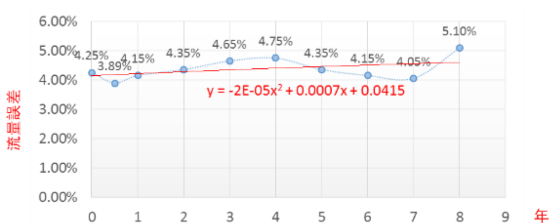
圖 4-13 流量計現場串聯比對精度衰退趨勢示意
