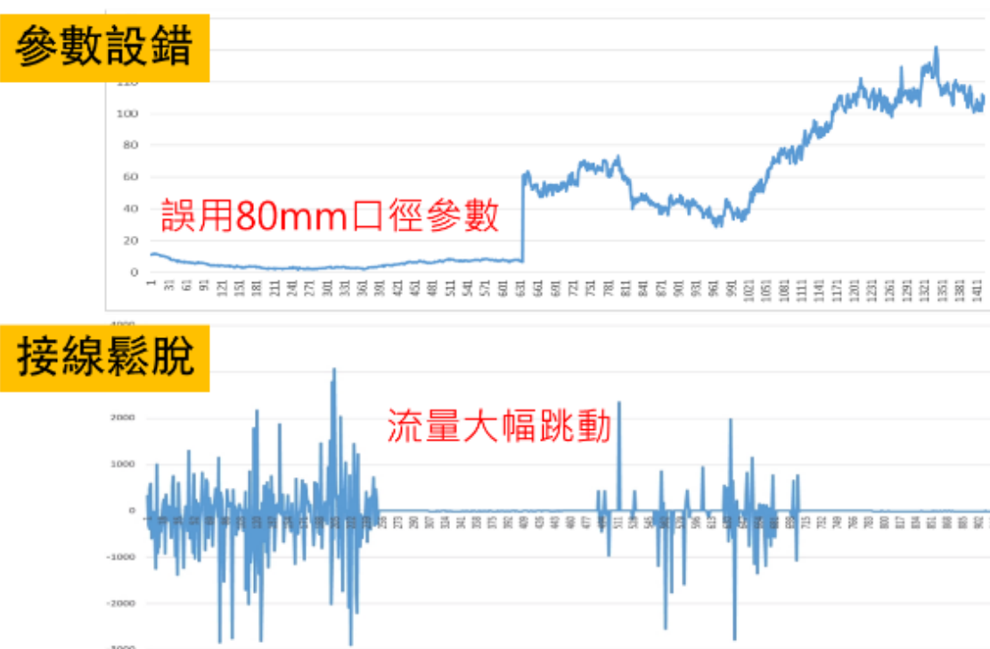
圖 4-9 DSM 流量計因未妥善安裝產生流量錯誤案例
