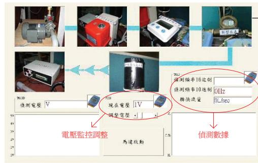
本自動讀取系統用 Visual Basic 編寫一圖控程式，搭配模組 A〈7520, 7021, 7012D〉用來控制數位式流量控制閥之輸入電壓及量測輸出之電壓，達到即時控制數位式流量控制閥之閥位。並搭配模組 B〈7520, 7080, 7044〉用來量測數位感測水流量器之輸出之頻率(HZ)，監測數位感測水流量器之系統流量數並傳回中控電腦。
