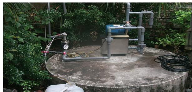
圖2 馬達直接抽水模擬試驗測試設備
