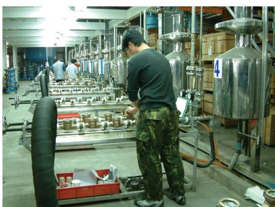
圖(1-1) 過去水錶校正組裝作業程序
