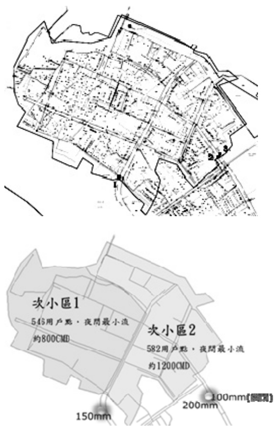
圖 4 旗津示範小區之次小區法檢漏作業
