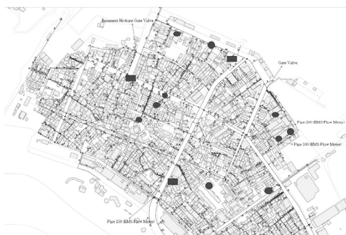
圖 13 主動檢漏成果(13 處漏水點)
