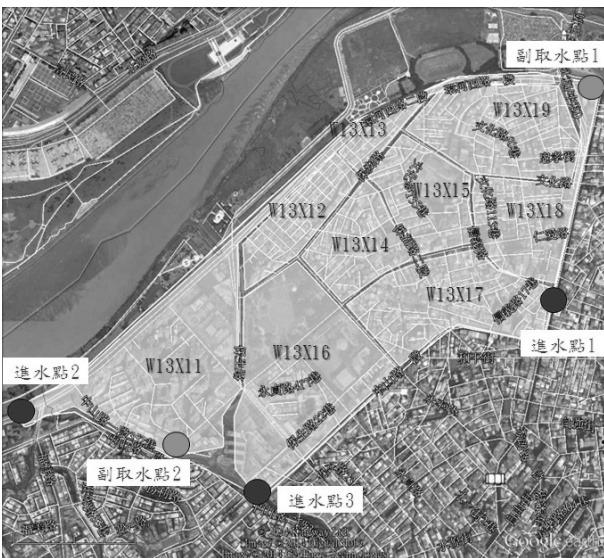
圖 7 永和二中區進水點位置
